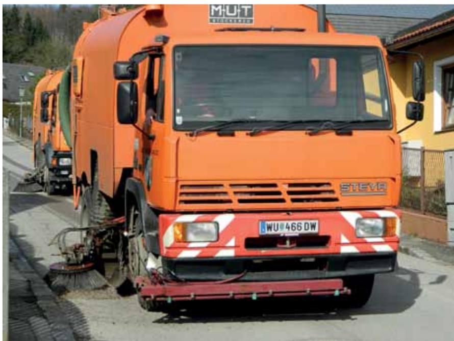
Anschliessend wurde das auch zerteilte und zerriebene Streugut von zwei Saugfahrzeugen und deren eingebauten Kkehrbürsten aufgenommen. Danach folgte eine Wassernachspülung, um den Staub wegzuwaschen.
